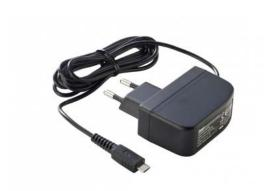
L'alimentation externe est livrée avec la GreenBox. Il est nécessaire d'insérer le connecteur mini USB dans le connecteur d'alimentation de la GreenBox.
